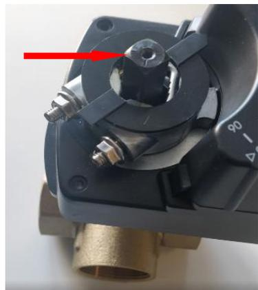
Если клапан смонтирован в систему, то положение открытых патрубков можно определить по рискам на торце вала клапана, которые показывают направления открытых патрубков.
